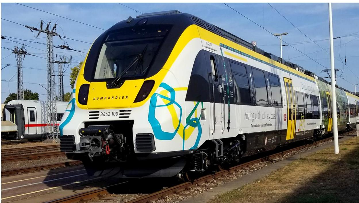
Железная дорога Niederbar nimer Eisenbahn готовит к вводу в эксплуатацию двухвагонный электропоезд Mireo Plus B с тяговыми аккумуляторами. Замена дизель-поездов на поезда Mireo Plus B позволит сократить выбросы порядка 11,5 тыс. т углекислого газа ежегодно. Тяговые аккумуляторы, обеспечивающие новым поездам запас хода более 90 км, будут подзаряжаться от контактной сети при движении по
