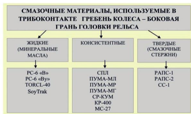
Рис. 1. Классификация смазочных материалов, используемых в контакте колесо – рельс
