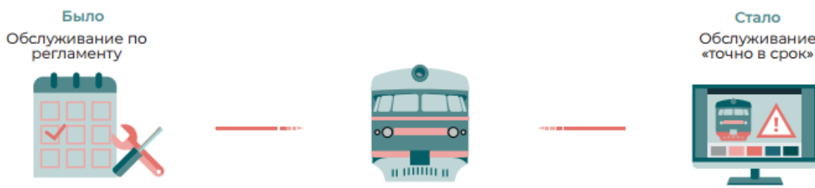
■ Рисунок 44. Переход от традиционного подхода в обслуживании подвижного состава к обслуживанию, основанному на Интернете вещей
