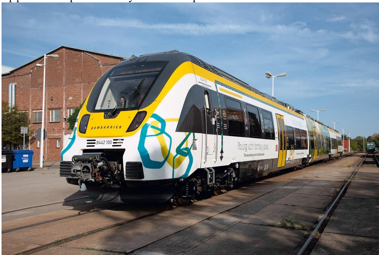
Электропоезд Talent 3 с тяговыми аккумуляторами постройки Bombardier Transportation на предприятии в Хеннингсдорфе
