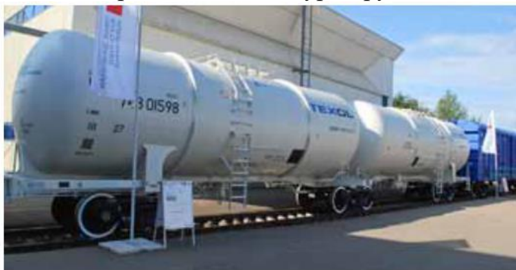
Рис. 3. Шестиосный вагон-цистерна сочлененного типа модели 15-629 для легковесных светлых нефтепродуктов производства «НПК ОВК»
