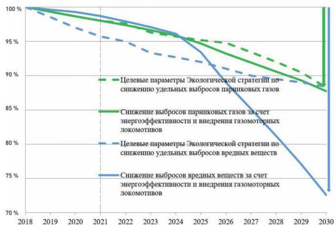
Рис. 5. Прогноз реализации инновационного сценария Экологической стратегии ОАО «РЖД» до 2030 года при замещении 25 % дизельного топлива природным газом, а также при поэтапном развитии эксплуатации газомоторных локомотивов
