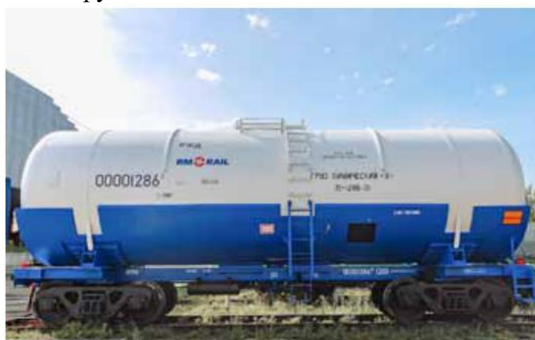
Рис. 6. Вагон-цистерна модели 15-1286-01 для химических грузов, оборудованный новой тележкой с нагрузкой на ось 25 тс модели 18-9891 постройки компании «РМ Рейл»
