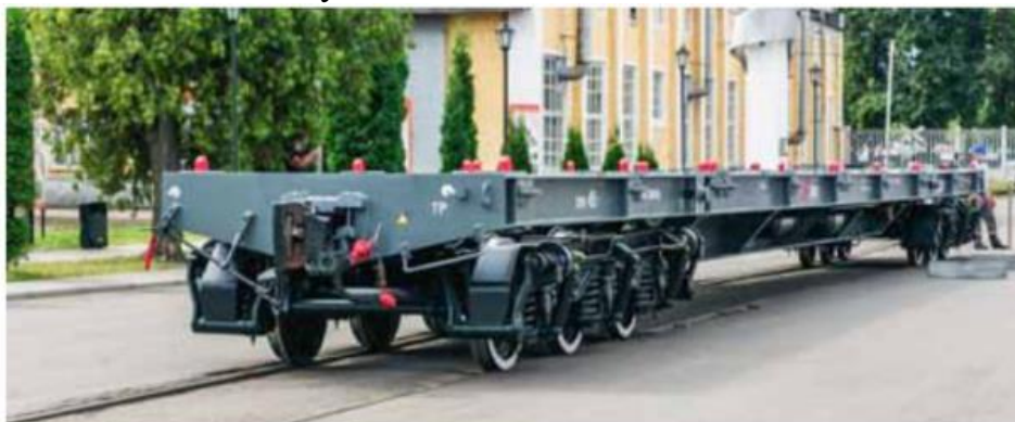
Рис. 1. Скоростная фитинговая шестисосная платформа модели 13-6704
