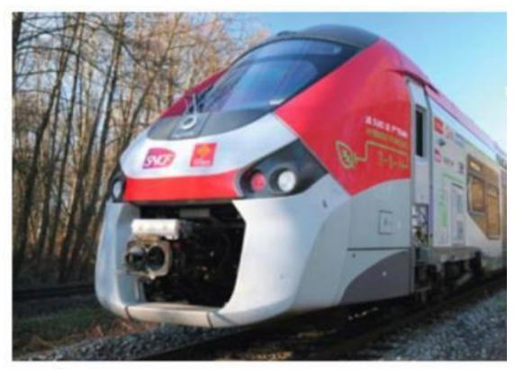
Поезд Règiolis производства компании Alstorm с гибридным тяговым приводом с питанием от контактной сети, дизеля и тяговых аккумуляторов для SNCF
