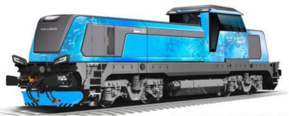
Маневровый локомотив HydrogenShunter 1000 производства компании CZ LOKO на водородном топливе
