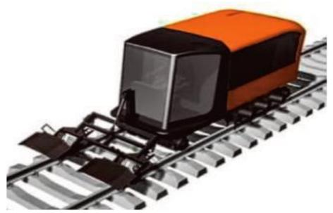
Модель модуля монтажа-демонтажа рельсовых скреплений проекта СТМ
