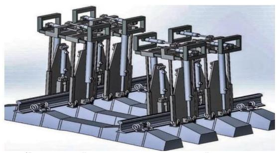
3D-модель устройства монтажа-демонтажа двуплечей пружины кручения промежуточного скрепления
