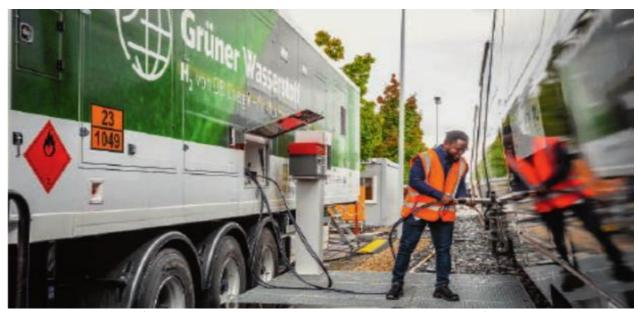
Мобильный пункт заправки поезда водородом, разработанный DB
