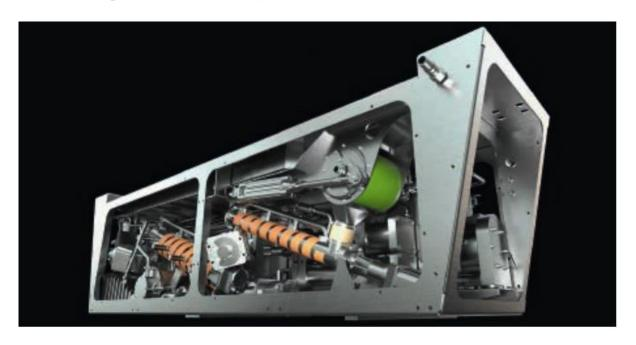
Литовская компания Viezo представила на выставке InnoTrans бортовую систему мониторинга состояния подвижного состава Powerail, включающую датчики вибраций и температуры, для питания которых используются полимерные пьезоэлектрические преобразователи. Система охватывает также бортовые концентраторы данных и аналитическое программное обеспечение на основе искусственного интеллекта.
