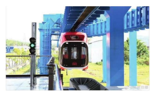
Новая технология магнитной подвески генерирует мало электромагнитного излучения, а стоимость ее строительства составляет примерно десятую часть стоимости строительства метро. Местные транспортные власти заявили, что после нескольких пробных запусков линия увеличится до 7,5 км, а ее максимальная рабочая скорость достигнет 120 км/ч.
