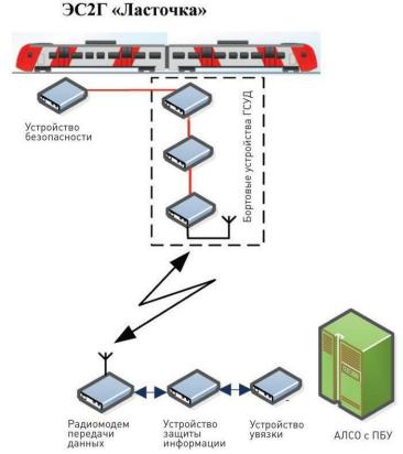
Структурная схема взаимодействия устройств при реализации функции ЛРК
