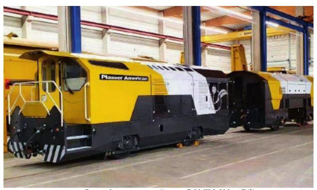
Рельсофрезеровальный поезд ROMILL Urban E(3)
