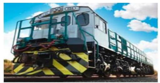
Локомотивы EMD Joule производства компании Progress Rail с тяговыми аккумуляторами для горнодобывающей компании BHP
