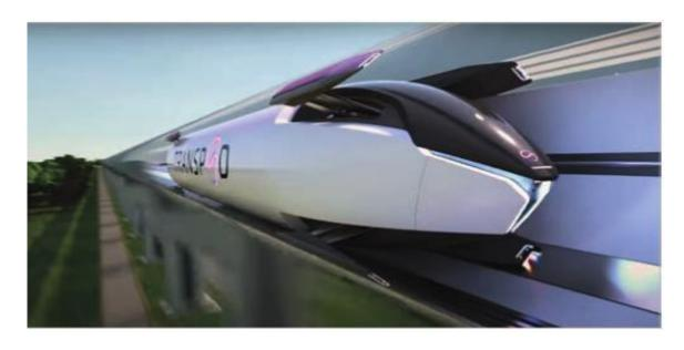
Для тяги капсулы используется линейный двигатель с активной системой управления в реальном времени, которая получает в том числе данные от датчиков, сканирующих пространство перед капсулой. Для уменьшения аэродинамического сопротивления предусмотрен отвод воздуха при движении капсулы через специальные воздуховоды, проходящие по всей ее длине.
