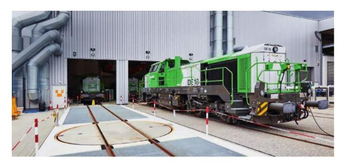
Важным событием стало появление версии SmartHybrid локомотива DE 18, отличающейся наличием тяговых аккумуляторных батарей.
