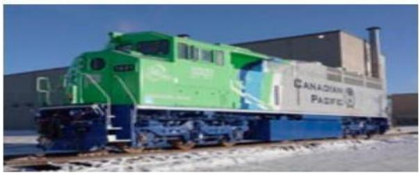
Локомотив, переоборудованный для работы на водородном топливе компанией Ballard Power Systems для железной дороги Canadian Pacific
