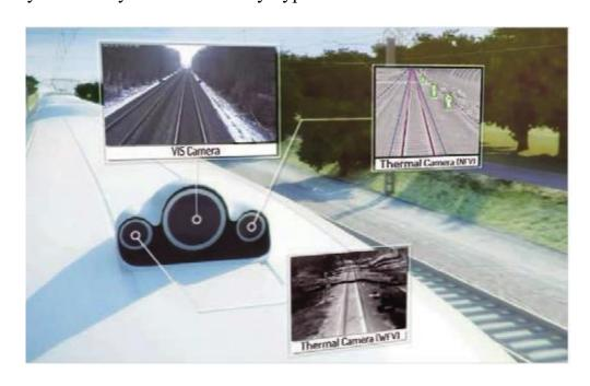
В рамках тестирования предполагается проверить возможность распознавания нескольких типов препятствий на железнодорожных путях или рядом с ними на различной дистанции от локомотива.
