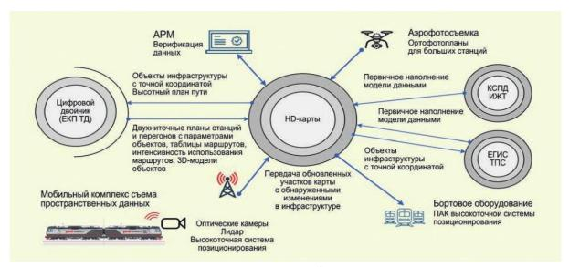
Концепция автоматического создания и обновления высокоточных электронных карт
