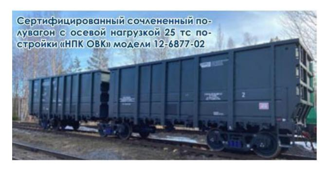
Кроме того, сочлененные полувагоны сокращают потребный парк и удельную стоимость перевозки груза. Конструкция таких полувагонов позволяет проводить выгрузку на вагоноопрокидывателях и/или через разгрузочные люки. Отечественными производителями вагонных весов разработаны устройства, способные взвешивать вагоны сочлененного типа как с расцепкой, так и без нее.
