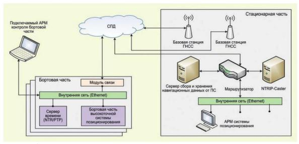
Общая структурная схема высокоточной системы позиционирования
