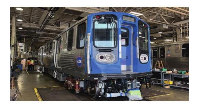
Усовершенствована система подвески не только придает поезду плавность хода, но и открывает возможность его эксплуатации на разных линиях с отличающейся высотой платформ благодаря ультразвуковым датчикам, позволяющим определять высоту платформы и автоматически подстраивать под нее высоту пола.
