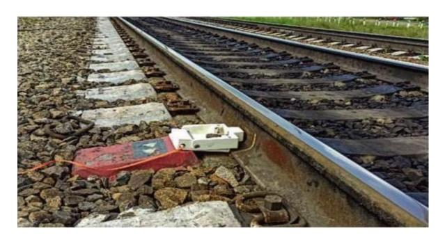
Оснащение бесстыкового пути контролирующим устройством КСТП-01
