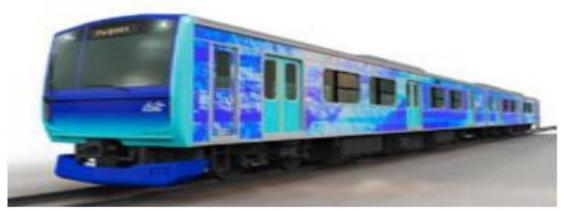
Поезд FV-E991 HYbari производства компании Hitachi и Toyota с гибридным водородно-аккумуляторным тяговым приводом для компании-оператора East Japan Railway
