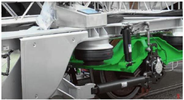
Одноосная тележка облегченного грузового вагона CFW
