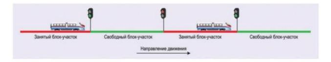
Метод подвижных блок-участков обходится без фиксирования блокучастков и стационарных сигналов светофора. Требуемое расстояние между двумя поездами состоит из тормозного пути при текущей скорости плюс некоторый запас прочности (10-15% от тормозного пути).
