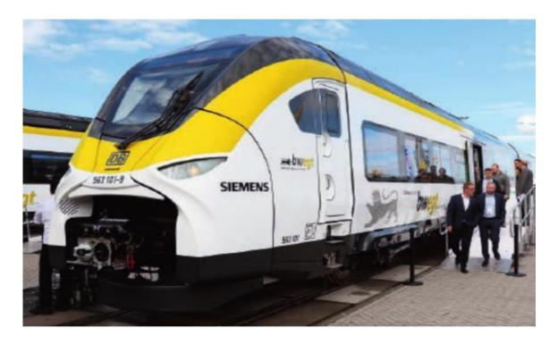
На выставке состоялся также премьерный показ двухвагонного поезда Mireo Plus H, который получает питание от водородных топливных элементов и литий-ионных аккумуляторов.
