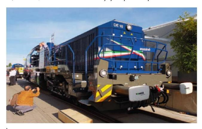
Локомотив DE 18 SmartHybrid оборудован дизельным двигателем MTU 12V 4000 мощностью 1,8 МВт, соответствующим европейским экологическим нормам уровня V.
