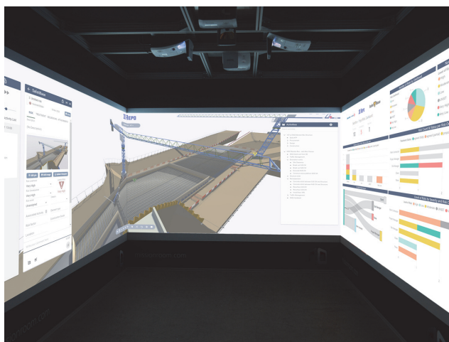
Рис. 1. Четырехмерная версия строительной площадки на иммерсивных дисплеях
