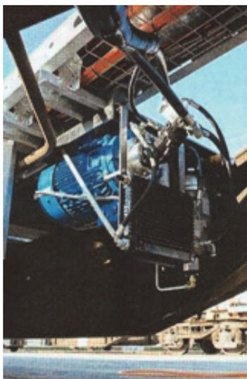
*Рис. 1. Генератор размещается под рамой платформы*
