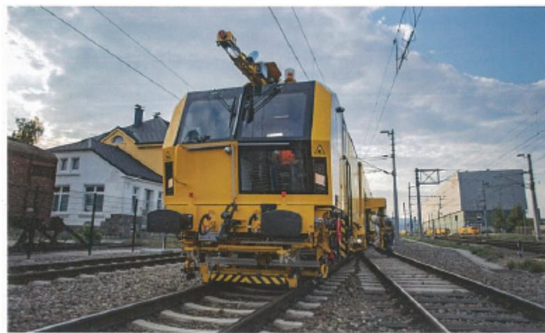
*Рис. 2. Путевая машина EM100VT производства компании Plasser & Theurer*
