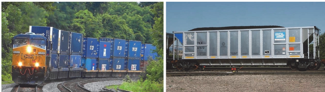
Рис. 1. Состав из платформ с контейнерами в два яруса и вагон для перевозки угля с кузовом из алюминия
