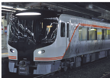
Рис. 2. Четырехвагонный дизель-аккумуляторный поезд HC-85
