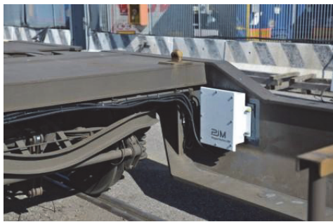
Рис. 1. Бортовые датчики PJM, установленные на вагонах
