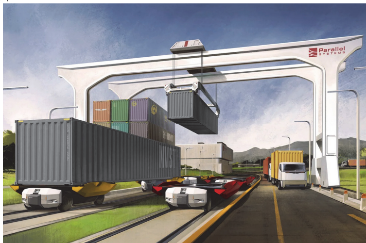
Рис. 2. Установка контейнеров на тележку
