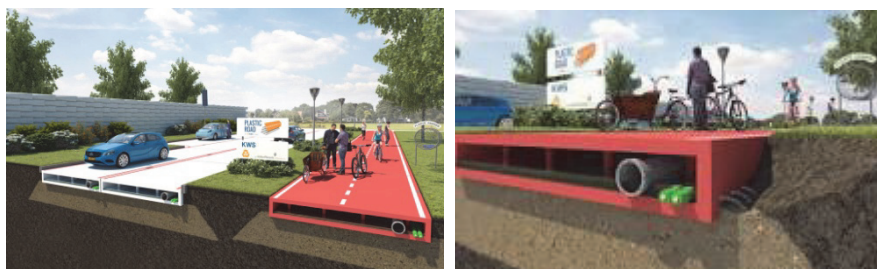
Рис. 1. Строительство модульной дороги из переработанного пластика
