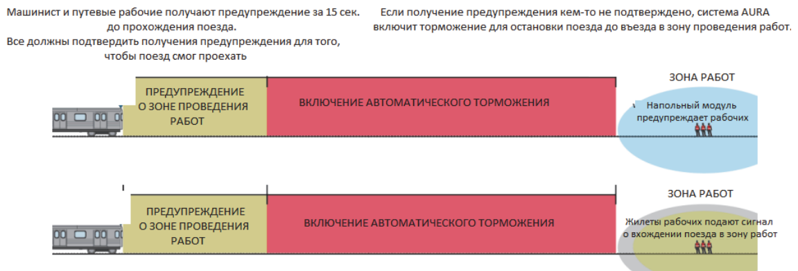
Рис. 4. Принцип действия проактивной системы защиты AURA RWPS
