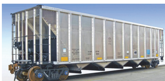
Рис. 1. Алюминиевый вагон open-top для перевозки угля AutoFlood IV производства FreightCar America
