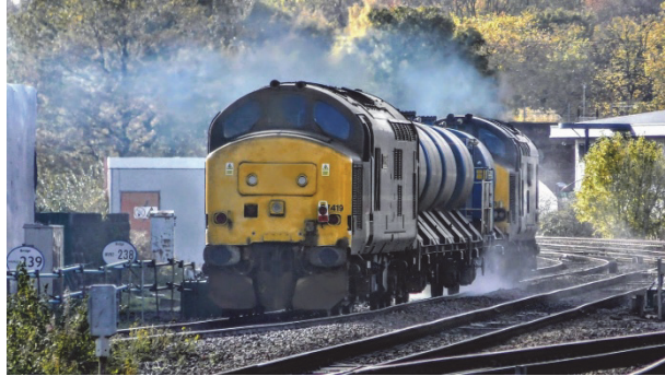
Рис. 1. Специальный поезд RHTT для очистки путей
