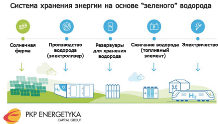
Рис. 1. Накопитель энергии на основе водорода
