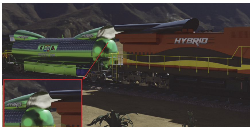
Рис. 3. Улавливание выхлопных газов локомотива для очистки установкой DAC
