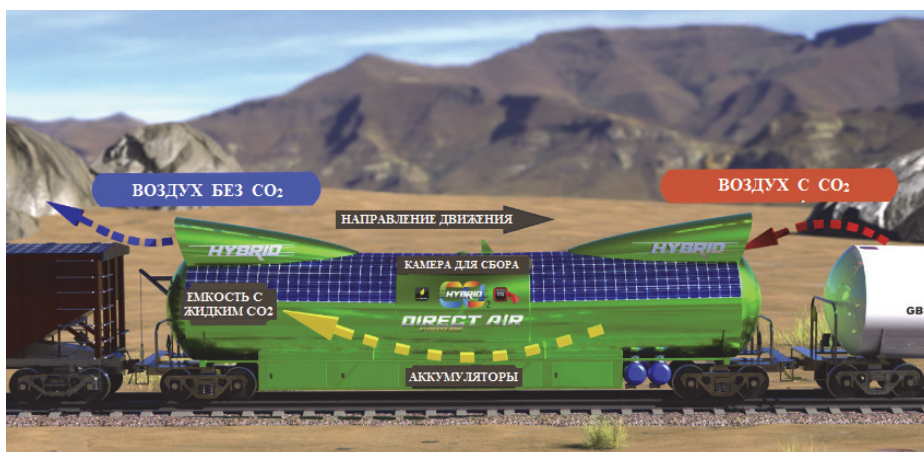
Рис. 2. Принцип действия железнодорожной установки DAC
