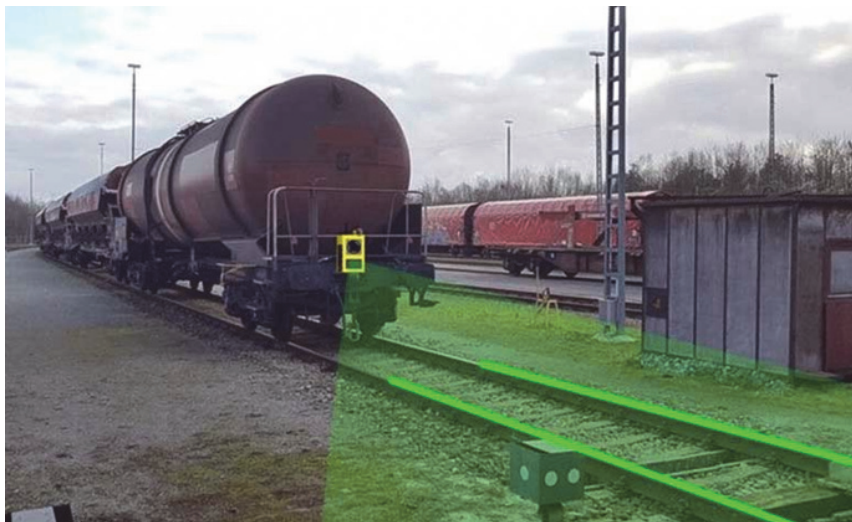
Рис. 1. Система помощи маневрирования осуществляет мониторинг пути за счет интеграции твердотельных датчиков 3D LiDAR Cube 1 от Blickfeld с полем зрения в 70 градусов и Cube Range 1 с возможностью оценки на расстоянии до 150 метров
