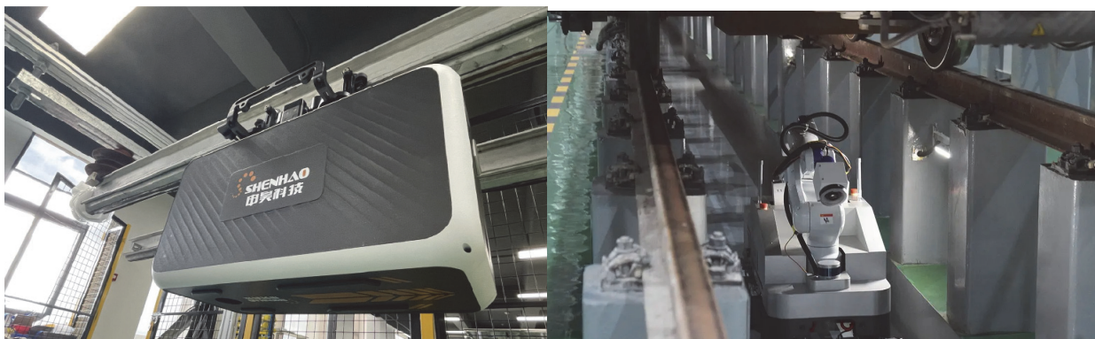
Рис. 4. Интеллектуальный робот Shenhao для осмотра контактной сети. Колесный инспекционный робот Shenhao TVIS 1000
