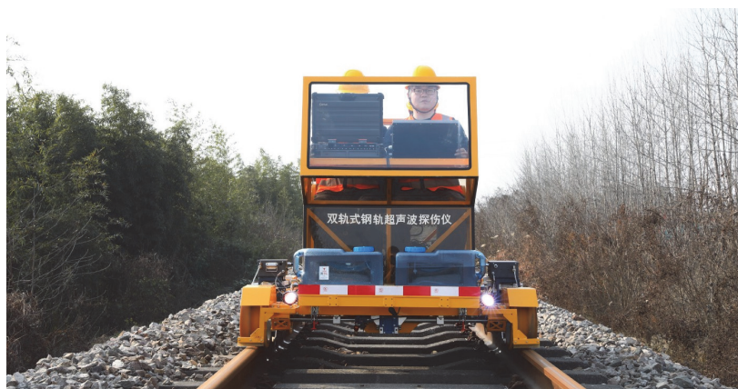
Рис. 3. Инспекционный самоходный робот Shenhao RIIS005
