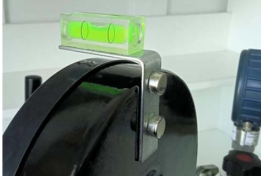
Рис. 2. Приспособление для контроля положения манометра
