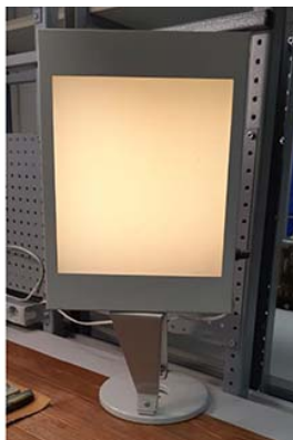
Рис. 3. Экран для сквозного просмотра контактов реле с регулируемым световым потоком
