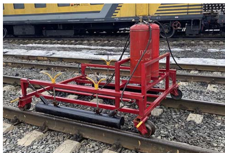
Рис. 1. Портативное нагревательное устройство для ввода рельсовых плетей в оптимальный температурный интервал
