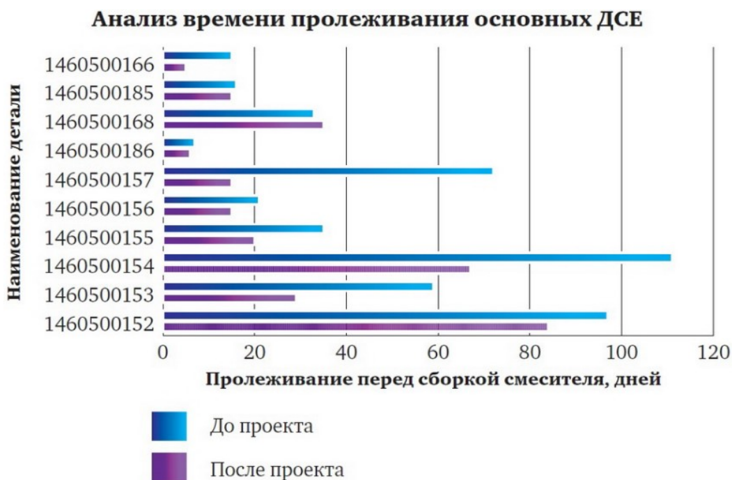
Рис. 3 Анализ времени пролеживания основных ДСЕ перед сборкой смесителя
