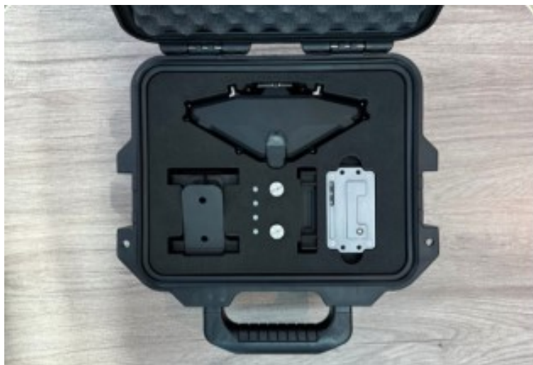
Рис. 16. Навигационная система для БПЛА, которая работает в зоне отсутствия GPS-сигнала
