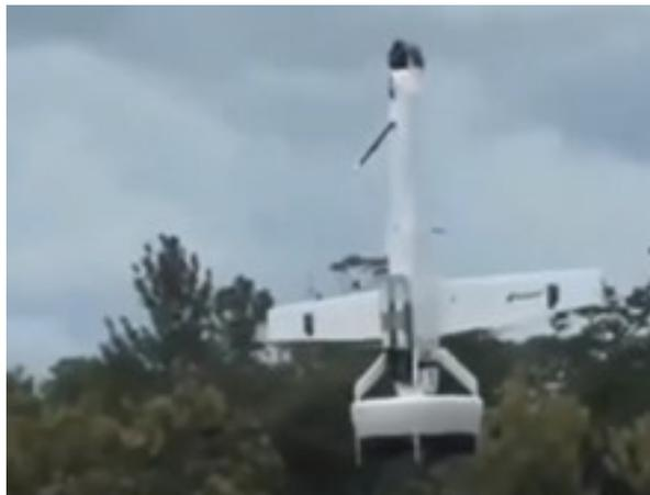
*Рис. 18. БПЛА с вертикальным взлетом и посадкой V-BAT*
