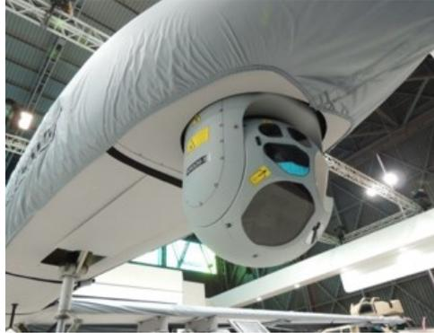
*Рис. 6. Бортовая система визуализации Argos-15*
