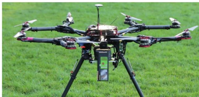
*Рис. 5. БПЛА с лазерным детектором метана и видеокамерой для обнаружения с воздуха утечек природного газа*
