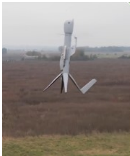
Рис. 9. Flexrotor – небольшой тактический беспилотник вертикального взлета
