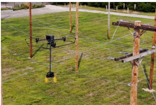
Рис. 6. Комплект для БПЛА, предназначенный специально для удаленной установки отпугивателей птиц на линиях электропередач
