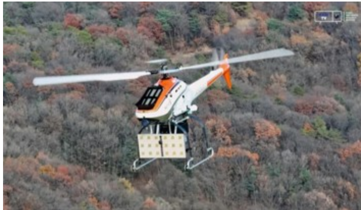
Рис. 8. Корейский институт аэрокосмических исследований (KARI) успешно испытал технологию беспроводной передачи энергии на дрон
