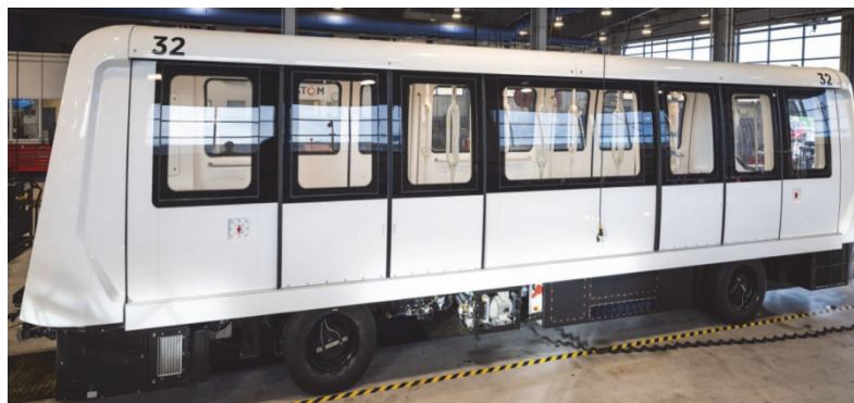
Рис. 7. Вагон беспилотного поезда Alstom для аэропорта Денвера
