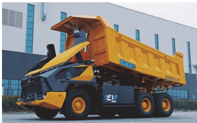
Рис. 4. Автономный, электрический грузовик XDR80TE-AT с искусственным интеллектом
