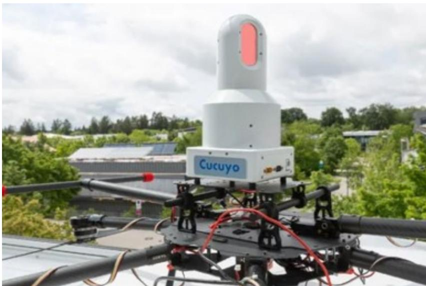
*Рис. 8. Лазерный терминал связи P-100 на беспилотных платформах*
