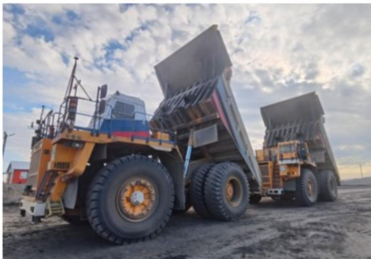
*Рис. 5. Роботизированные самосвалы*
