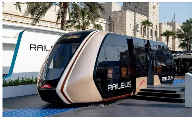
*Рис. 3. Прототип рельсового автобуса из переработанных материалов*
