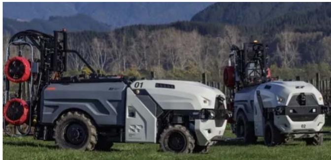
*Рис. 3 Автономный трактор Prosper компании Robotics Plus*
