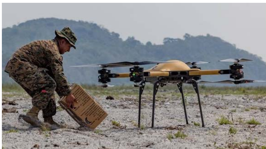
Рис. 7. БПЛА TRUAS (Tactical Resupply Unmanned Aircraft System – «Тактическая беспилотная авиационная система для пополнения боеприпасов»)
