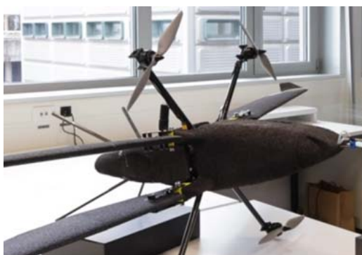
Рис. 3. Квадрокоптер-конвертоплан с поворачиваемыми крыльями
