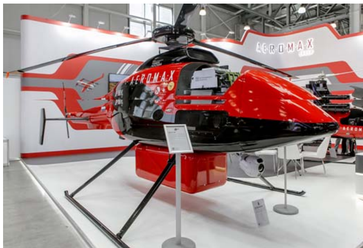
Рис. 5. БПЛА SH-750 с силовой установкой на основе водородных топливных элементов
