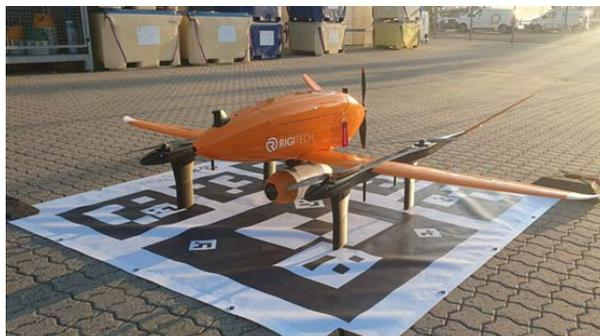
*Рис. 3. Платформа доставки грузов Eiger*
