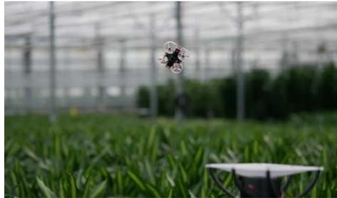
*Рис. 4. БПЛА в составе системы борьбы с насекомыми-вредителями*
