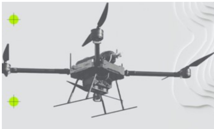
Рис. 13. Дрон на водороде, который можно использовать для мониторинга нефте- и газопроводов, линий электропередачи
