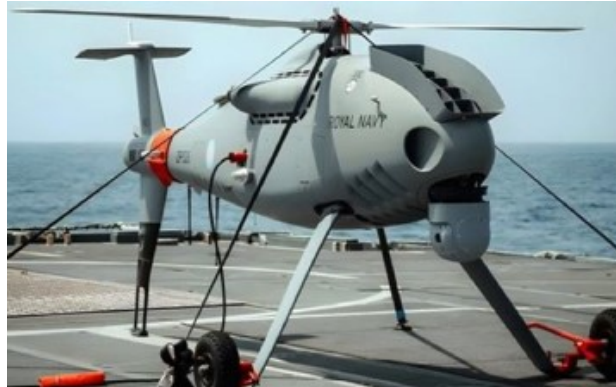
Рис. 23. БЛА Peregrine вертолетного типа
