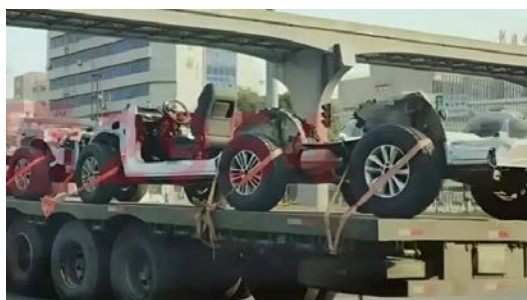
Рис. 10. Прототип трёхосного автомобиля с несущим кузовом
