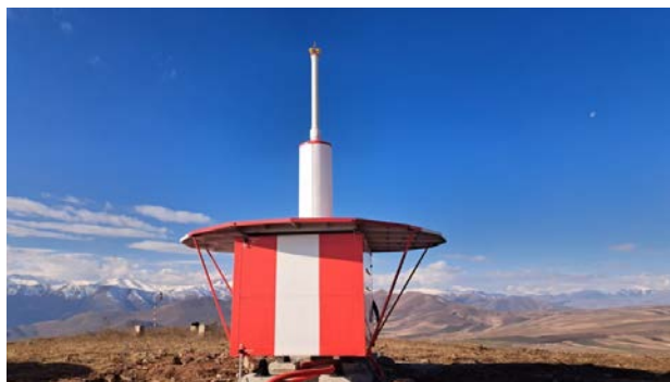
Рис. 12. Всенаправленный радиомаяк VOR/DME 2700 работает в ОВЧ-диапазоне и может одновременно вести до 200 самолетов
