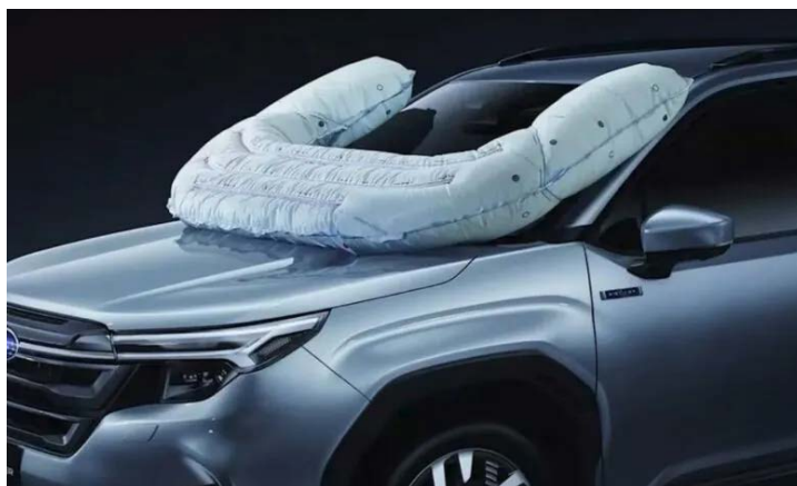
Рис. 9. Внешняя подушка безопасности для защиты велосипедистов
