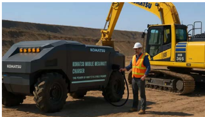
Рис. 30. Мобильная зарядная станция MWCS для электрооборудования на стройплощадках
