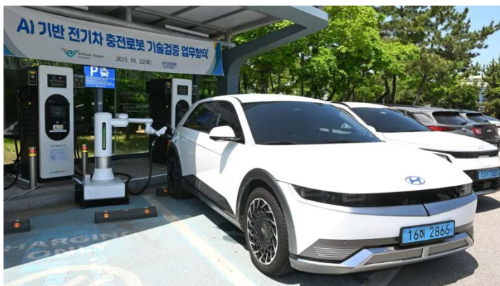
Рис. 11. Роботизированная зарядная станция для электромобилей
