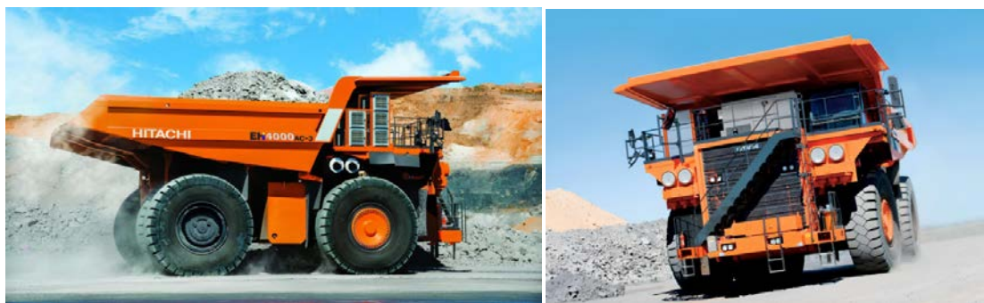
Рис. 11. Электрический карьерный самосвал массой 240 тонн
