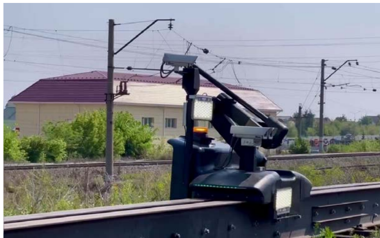
Рис. 3. Робототехнический комплекс для расцепки вагонов при сортировке
