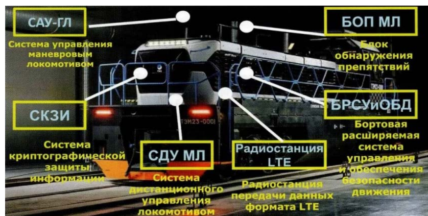
Рис. 2. Схема оборудования тепловоза ТЭМ23 с системой «Автомашинист»
