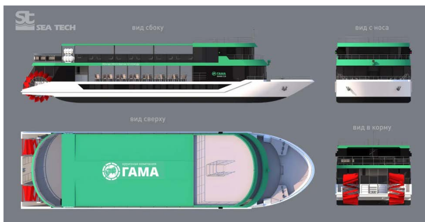
Рис. 13. Беспилотный колесный 200-местный электроход строится в России
