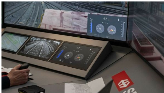
Рис. 4. Дистанционное управление локомотивом на действующей сортировочной станции
