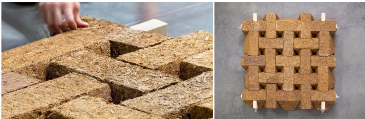
Рис. 14. Инновационный сахарный бетон
