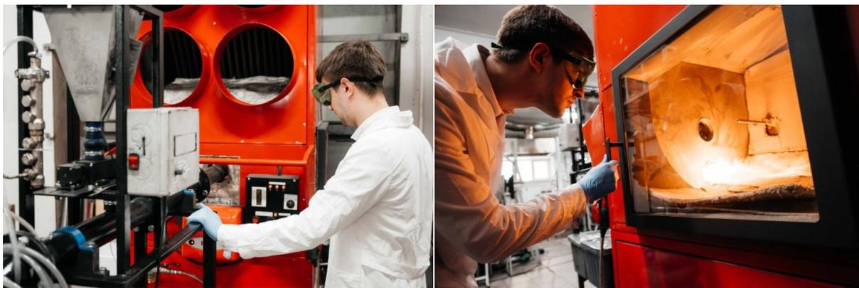
*Рис. 15. Стенд по сжиганию топлива в экспресс-формате*
