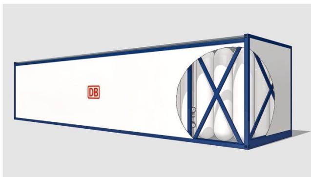
*Рис. 2. Контейнер для перевозки газообразного водорода*
