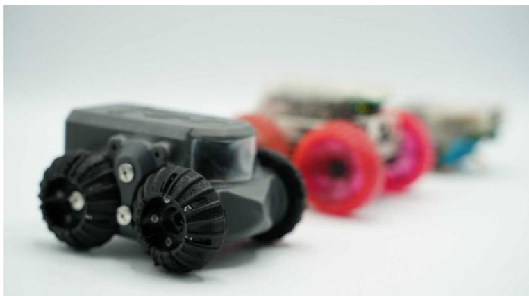
*Рис. 13. Микророботы для обследования труб*
