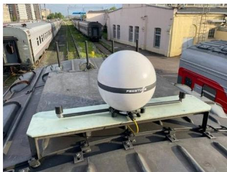
*Рис. 1. Испытания терминала спутниковой связи*
