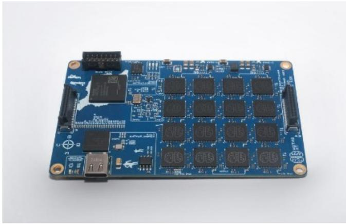
Рис. 10 прототипов AltAI-1 на плате с USB-портом
