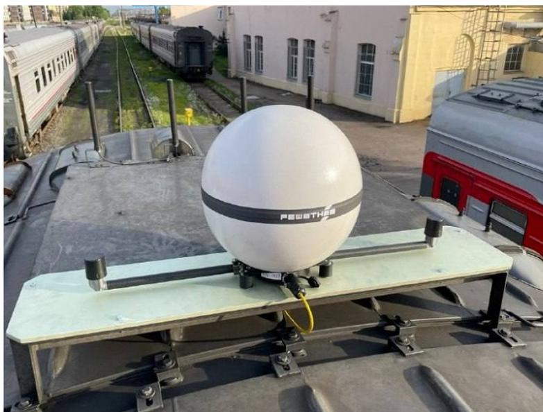
Рис. 9. Терминал РС-30М
