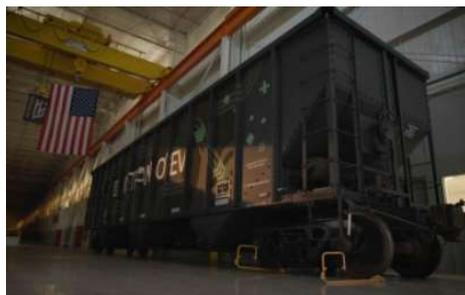
*Рис. 2. Первый грузовой вагон с накопителями на аккумуляторных батареях системы ReVolt*
