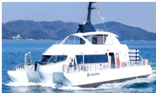
Рис. 14. Пассажирское судно Hanaria с гибридной силовой установкой
