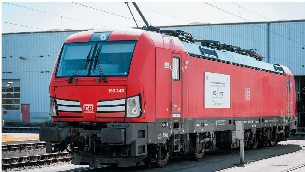
Рис. 2. Электровоз серии 193 (Vectron)
