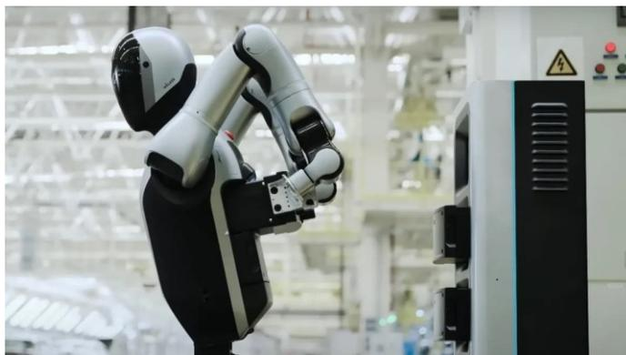
*Рис. 19. Робот Walker S2 самостоятельно меняет аккумуляторную батарею*
