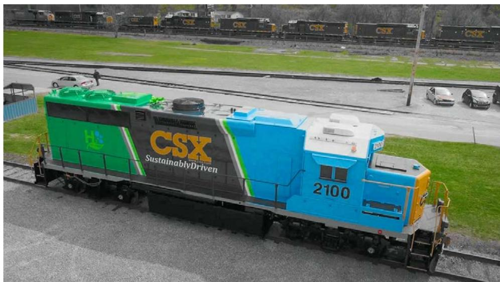
*Рис. 1. Локомотив с питанием от водородных топливных элементов*
