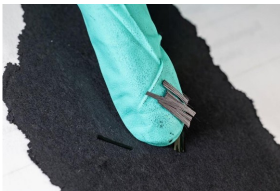
Рис. 18. Несмотря на то, что эти фрагменты углеродного волокна едва покрывают кончик пальца, они являются самыми длинными из тех, что используются в аккумуляторных плёнках, и обеспечивают более быструю передачу электронов
