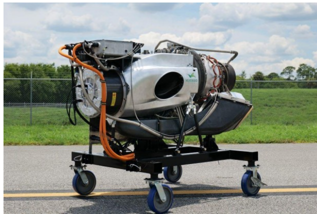
Рис. 2. Прототип гибридно-электрической силовой установки VH-4T-415
