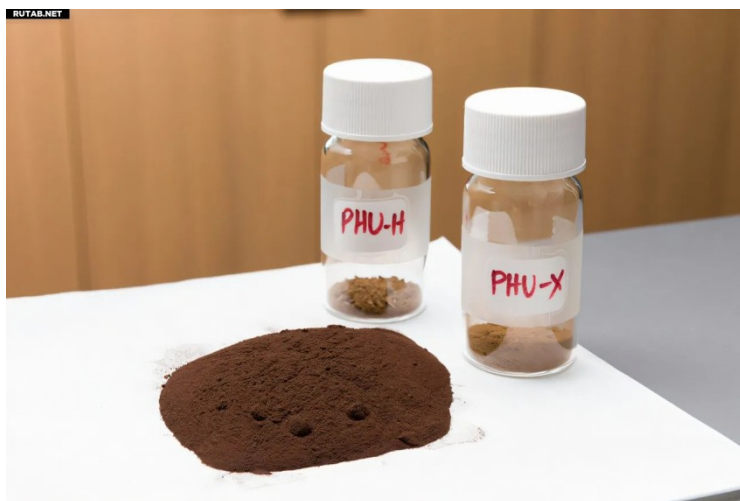
Рис. 16. Порошок лигнина и образцы полиуретана на его основе в лаборатории Хо Ён Чунга в Университете штата Флорида
