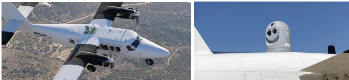
Рис. 12. Оптический терминал производства General Atomics Electromagnetic Systems, установленный на фюзеляже канадского самолета DHC-6 «Твин Оттер»
