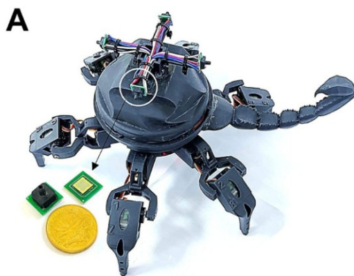
Рис. 16. Шестиногая ходячая платформа, вдохновленная скорпионом, оснащена четырьмя датчиками восприятия поля скоростей вблизи тела BPPS
