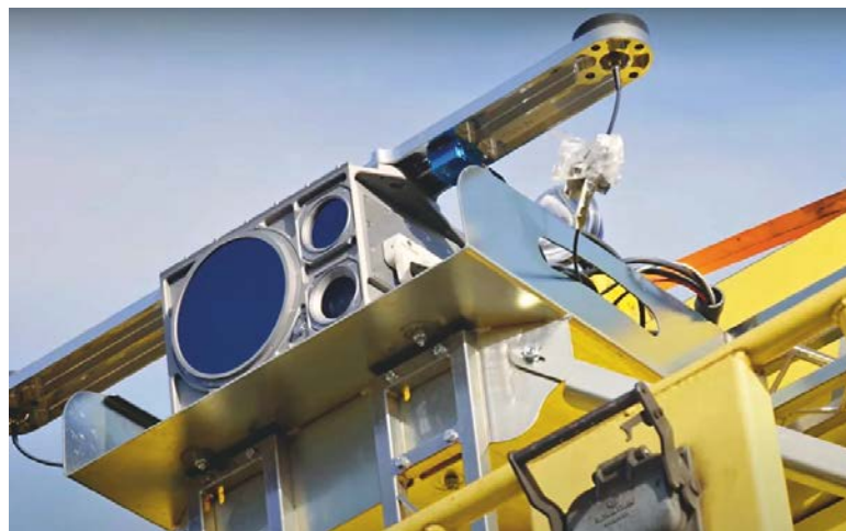
Рис. 3. Система технического зрения от Elta на маневровом локомотиве оператора Lineas, проходившем испытания в Нидерландах
