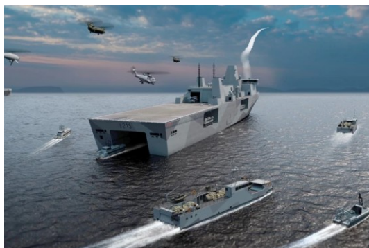
Рис. 8. На корабле Ellida Strike есть палуба для спуска и подъёма десантных кораблей.
