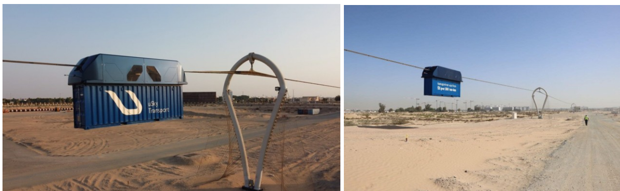
Рис. 25. Подвесной бирельсовый грузовой юнимобиль. Предназначен для транспортировки специальных контейнеров в тропических условиях
