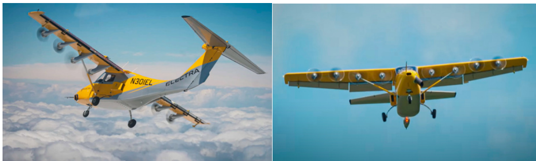
Рис. 5. Гибридно-электрический самолет класса eSTOL EL-2 Goldfinch
