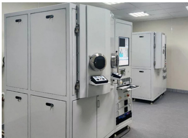
Рис. 18. Вакуумные установки для нанесения интерференционного покрытия на изделия
