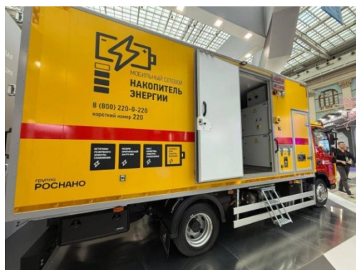
Рис. 21. Первая мобильная система накопления энергии
